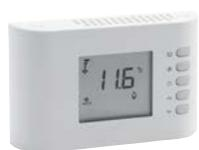
**Funzioni principali:** accensione e spegnimento dell'unità - regolazione temperatura ambiente - selezione riscaldamento / raffreddamento manuale o automatica - selezione 3 velocità manuale o automatica - display per lettura / visualizzazione temperatura ambiente e set point - comando valvole modulanti (0-10 Vdc) e motore ECM o asincrono - valvole On / Off e motore ECM - programmabilità delle funzioni - CONFIGURAZIONE VALVOLE ON / OFF E MOTORE ASINCRONO NON COMPATIBILE.
