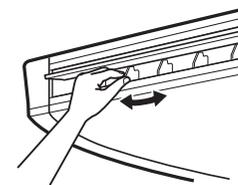
**■ Tipi a cassette a 1 via (serie YH) e da pavimento in vista****◆ Regolazione della direzione e dell'oscillazione**
