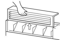
**4** Invertire la direzione di uscita e reinstallare la griglia sull'unità.
