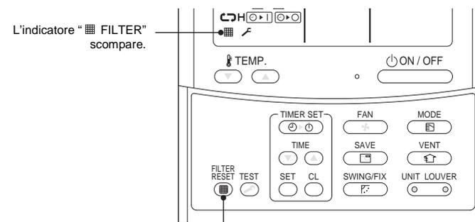
Una volta eseguita la pulizia occorre premere il tasto "FILTER RESET".
