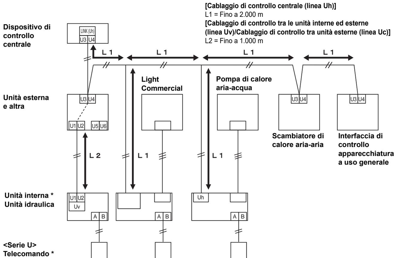
\* Le specifiche di cablaggio nello schema del sistema di cui sopra sono le stesse anche quando l'unità interna o il telecomando sono diversi dalla serie U.
