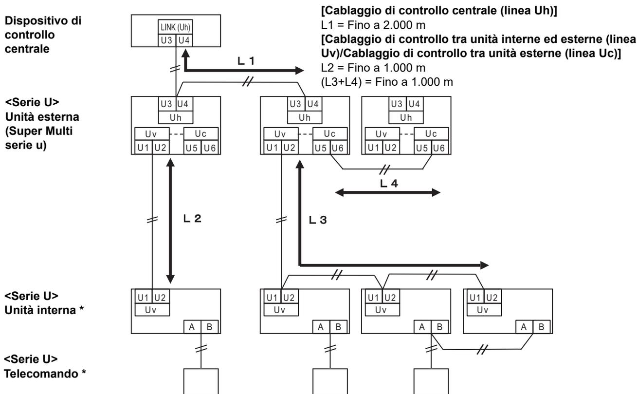
\* Le specifiche di cablaggio nello schema del sistema di cui sopra sono le stesse anche quando l'unità interna o il telecomando sono diversi dalla serie U.
