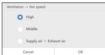
È possibile impostare la velocità ventola del ventilatore collegato all'unità scambiatore di calore aria-aria o al condizionatore d'aria. Le opzioni visualizzate dipendono dal modello.
