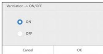
È possibile portare su ACCESO/SPENTO il funzionamento del ventilatore collegato agli scambiatori di calore aria-aria o ai condizionatori d'aria.
