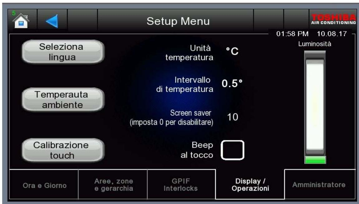
La temperatura può essere impostata per °C & °F. È inoltre possibile impostare gli incrementi di temperatura a 0,5°C o 1°C. (0,5°C funziona solo se il telecomando supporta questo) Il tempo dello screen saver è in minuti. Se non si desidera disattivare il timeout dello screen saver su 0 per disattivare questa funzionalità.
