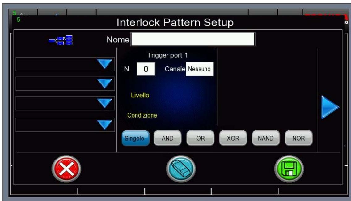
In questa finestra è possibile creare fino a 10 interblocchi separati. Nella configurazione del pattern di interblocco sono disponibili due porte trigger che consentono vari tipi di operazioni. È possibile selezionare il livello, la condizione e il tipo di logica che si desidera applicare.
