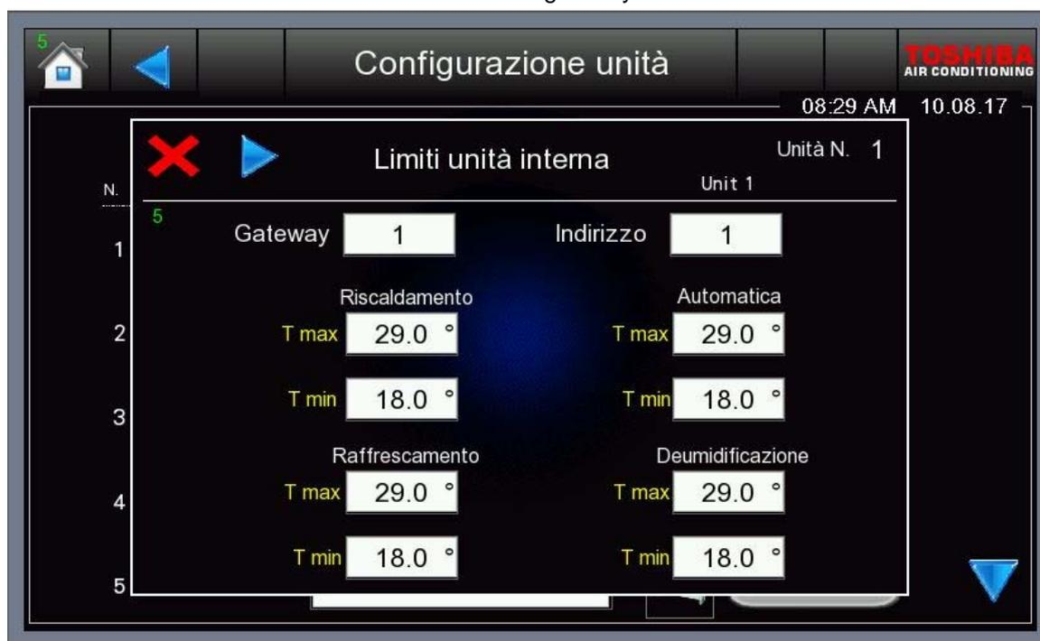
Nell'angolo in alto a sinistra della finestra di personalizzazione (impostazione dell'unità interna - Limiti) è possibile premere una freccia blu. Per portarvi alla schermata di personalizzazione successiva. In questa schermata è possibile applicare restrizioni alle funzioni che un'unità interna può controllare. (Le restrizioni di fabbrica si basano sul tipo di unità interna selezionata, assicurarsi di selezionare l'unità interna corretta nella schermata del tipo)
