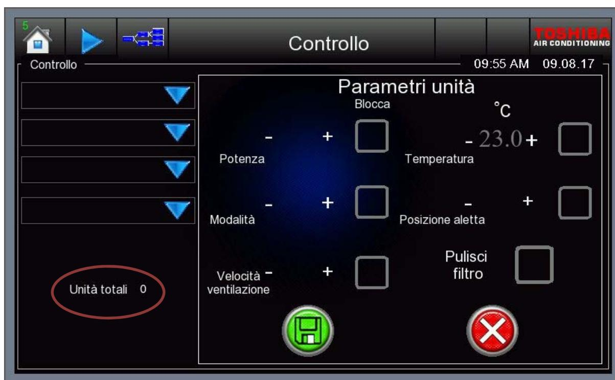
The La schermata di controllo principale consente di impostare lo stato di alimentazione, lo stato di funzionamento, lo stato del ventilatore, lo stato della temperatura, il diffusore Stato e reset del filtro. Le caselle di selezione del blocco devono essere premute una volta per abilitare la serratura e due volte per sbloccare. Quando si blocca un lucchetto verrà visualizzato nella casella di selezione. Quando sbloccato, la casella di selezione sarà Chiara Ma hanno un bordo bianco in grassetto
