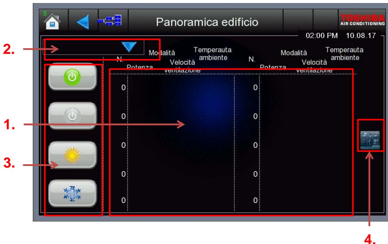
1. Nella schermata dettagliata panoramica edificio è possibile visualizzare lo stato di un massimo di 10 unità interne in una sola volta. La panoramica mostrerà ID dell'unità, lo stato di alimentazione, stato Mode, lo stato della ventola e della temperatura ambiente
