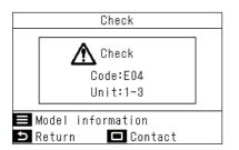
Quando si verifica un errore nel condizionatore d'aria, il codice di controllo e il numero dell'unità interna lampeggiano sul display del telecomando.
