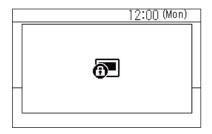
Blocchi delle operazioni applicati tramite controllo centrale
