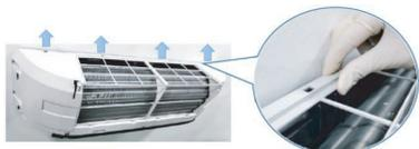
5. Aprire leggermente la parte inferiore del pannello anteriore, quindi tirare la parte superiore del pannello anteriore verso di sé per rimuoverlo come mostrato nella figura.
