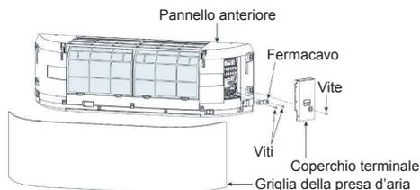
3. Rimuovere la vite di fissaggio (2 pezzi) sul pannello frontale.
