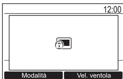
Effetti del blocco attivato con il controllo centralizzato
