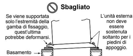
Se viene supportata solo l'estremità della gamba di fissaggio, quest'ultima potrebbe deformarsi. L'unità esterna non deve essere sostenuta soltanto per i piedini di appoggio.
