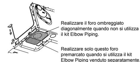
Dopo il cablaggio, rimuovere l'isolante termico fornito nella piastra superiore a forma di tubo e quindi sigillare il foro premarcato.
