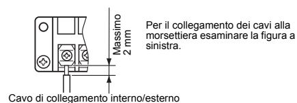
Cavo di collegamento interno/esterno
