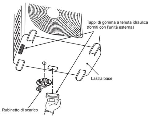
2. Installare il rubinetto di scarico e un tubo di scarico disponibile in commercio (con diametro interno da 16 mm) e scaricare l'acqua. (Per la posizione di installazione del rubinetto di scarico, consultare lo schema di installazione delle unità interna ed esterna.)
