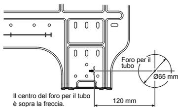
1. Dopo aver determinato la posizione del foro per il tubo con la lastra di installazione (➔), trapanare il foro per il tubo (Ø65 mm) con una leggera inclinazione a scendere verso l'esterno.
