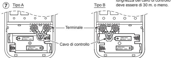
\* I terminali per il cablaggio possono essere a destra (tipo A) o a sinistra (tipo B), a seconda del controller imballato nel confezione.
