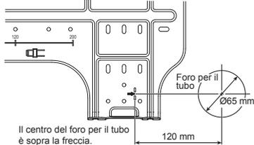
1. Dopo aver determinato la posizione del foro per il tubo con la lastra di installazione (➔), trapanare il foro per il tubo (Ø65 mm) con una leggera inclinazione a scendere verso l'esterno.
