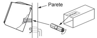
Tagliare un pezzo di SPACER dalla confezione dell'unità interna, arrotolarlo e inserirlo tra l'unità interna e la parete al fine di inclinare l'unità interna per un funzionamento più efficiente.
